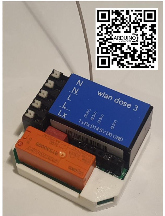
Dieser Schalter passt in einer tiefen Schalterdose hinter eine Steckdose oder Lichtschalter. Er hat einen Ausgang mit maximal 8A und zwei Eingänge zum anschließen von einem Taster und/oder einem Schalter. Das Relais ist über die Eingänge, über MQTT oder über eine HTTP Anfrage schaltbar. Zum Beispiel über eine HTTP-Widget-App im Smartphone.
